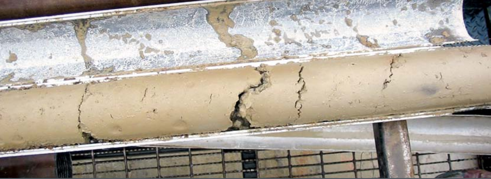
FORMACIÓN DE ARCILLA EN UN CILINDRO SACATESTIGOS PARTIDO
