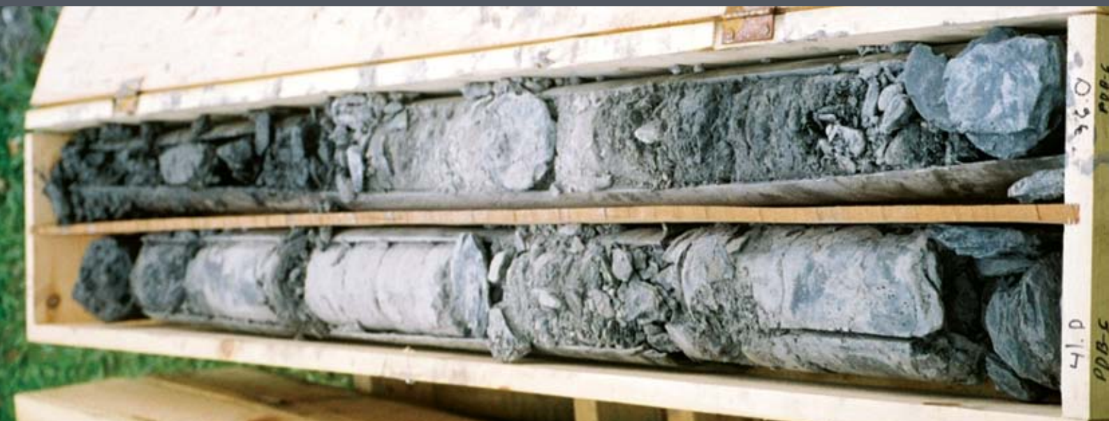
FORMACIÓN DE LECHO ROCOSO METEORIZADO Y COMPETENTE
